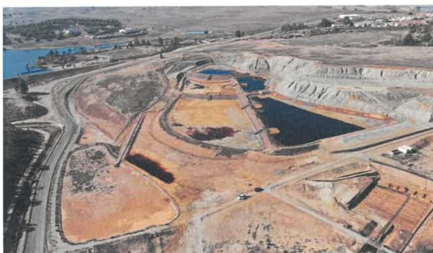
Figura 5.17. Fotografia área da antiga área mineira de Aljustrel, lagoas de decantação e evaporação
