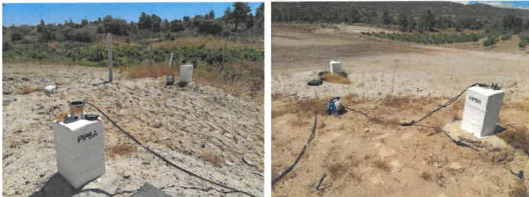
Detalhes da monitorização das águas subterrâneas em piezómetros situados na envolvente da célula de confinamento (Mortórios)
