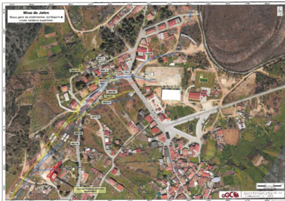
Mapa de Ocorrência das subsidências com sobreposição às galerias mineiras
