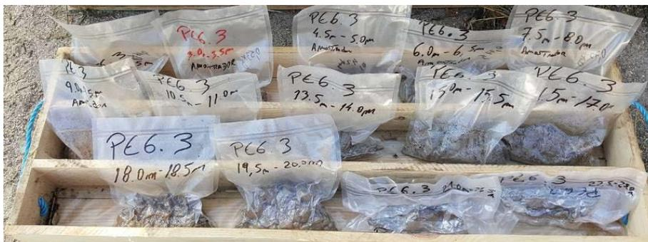
Amostras recolhidas na escombreira principal a diferentes profundidades destinadas à caracterização geoquímica e ensaios de lixiviação
