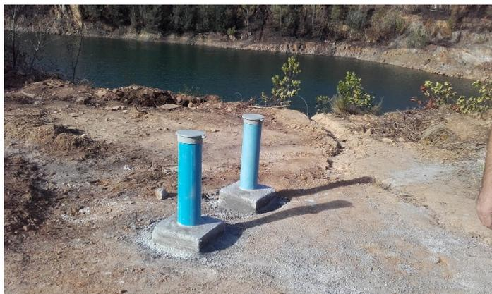
Pares piezométricos (superficial e profundo) construídos na área mineira de Mondego Sul junto à corta
