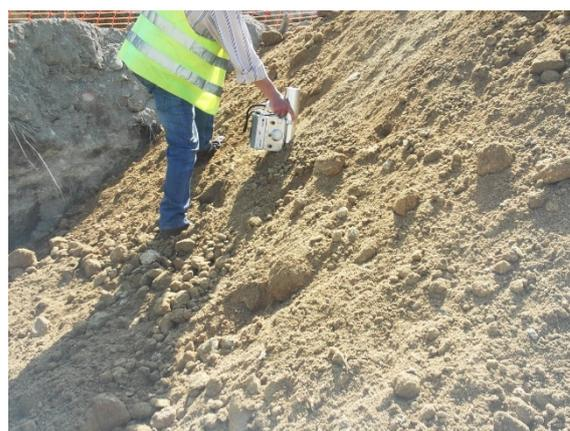
Execução de controlo radiométrico na descontaminação dos solos no edifício "Escritórios" (06.2018)
