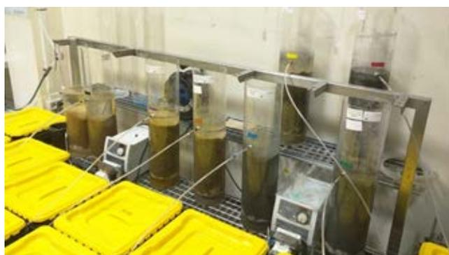
**Ensaio laboratorial para determinação da composição química dos lixiviados gerados em São Domingos**
