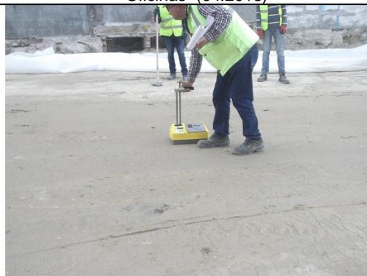
Execução de ensaios de compactação nos pavimentos do edifício "Oficinas" (04.2018)
