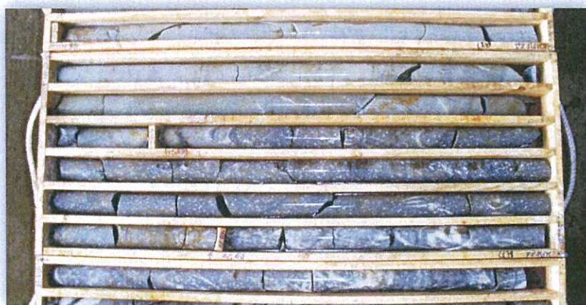
Aspecto das unidades vulcânicas ácidas (parte inferior da foto) e básicas na sondagem MM04.
