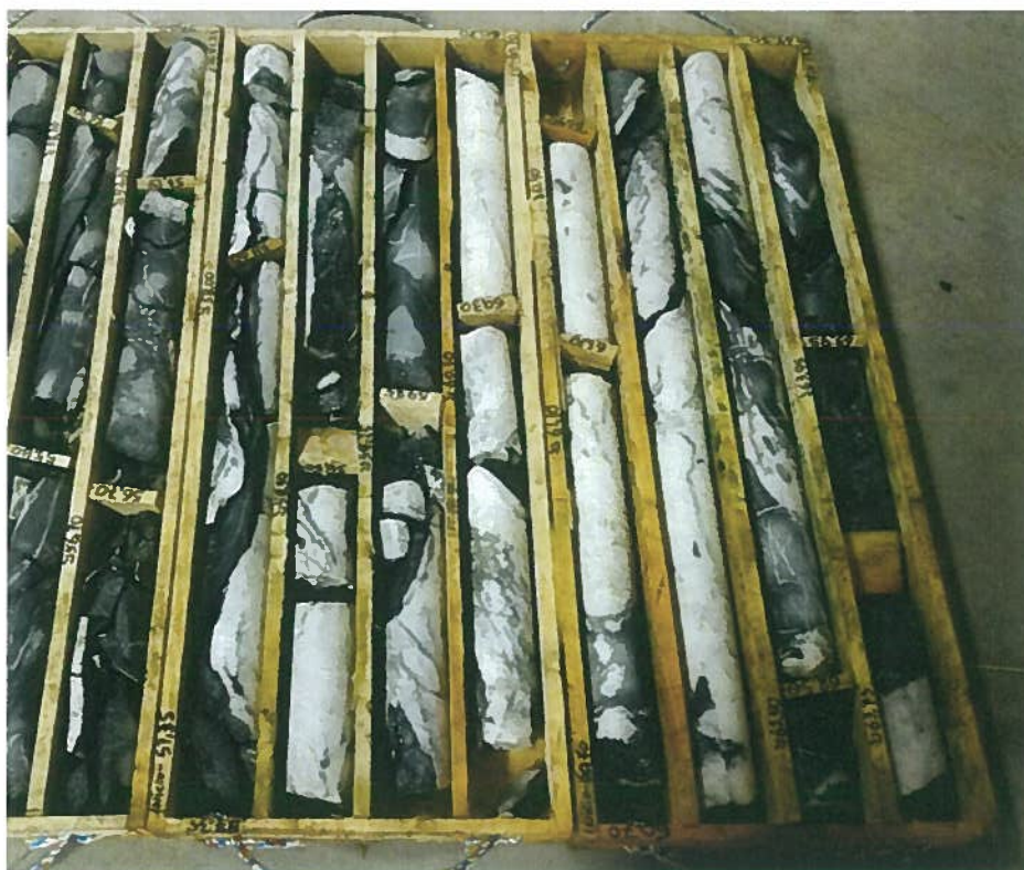
Interseção de filão em sondagem realizada no setor de Escádia Grande
